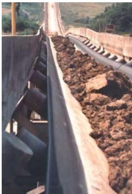
В случае особых потребностей (в частности нагрузки из-за большой протяженности конвейера и особых условий эксплуатации) в серии Extra присутствуют монопрокладочные конвейерные ленты с каркасом из одного слоя, изготовленного из арамидных волокон (D).
