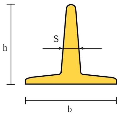
Ts наклонная высота 70 и 110 мм
