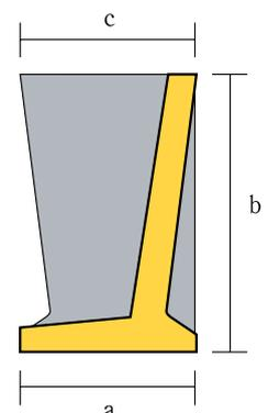
Волнообразные боковые стенки конфигураций 1 или 2 могут располагаться на ленте в 2 или более рядов, соответственно используемой ширине ( $L_u$ ) транспортировки.
