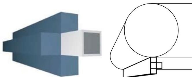
Cross scraper — 3 скребка на металлическом профиле, скребки меняются поворотом профиля вокруг оси. Быстрая и удобная замена.
